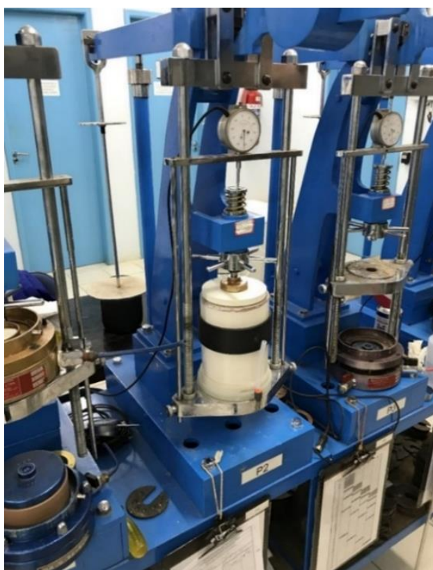
Figura 7 – Amostra na prensa de adensamento Bishop
