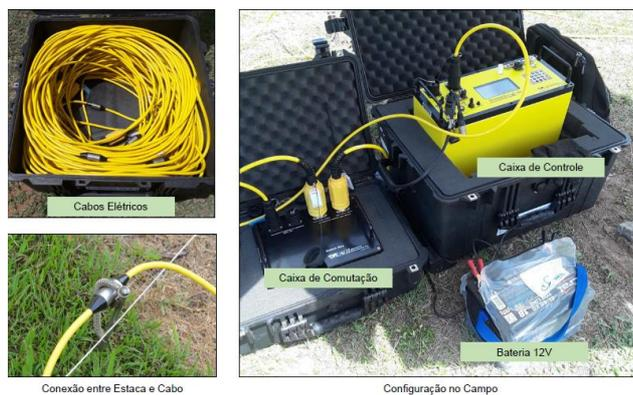
**Figura 3. 6 Exemplo de configuração de aparelho resistímetro**
