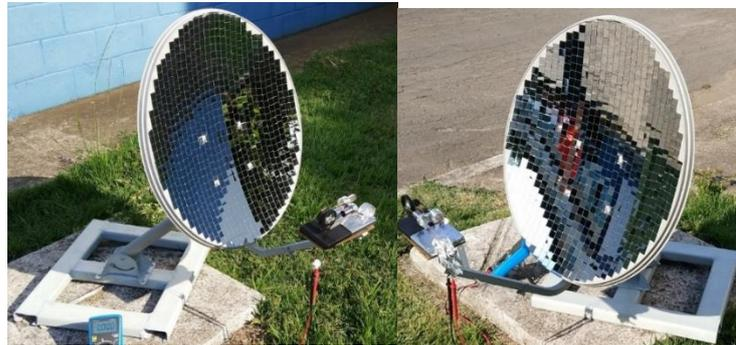
Figura 14: Vista completa do protótipo heliotérmico de disco parabólico
