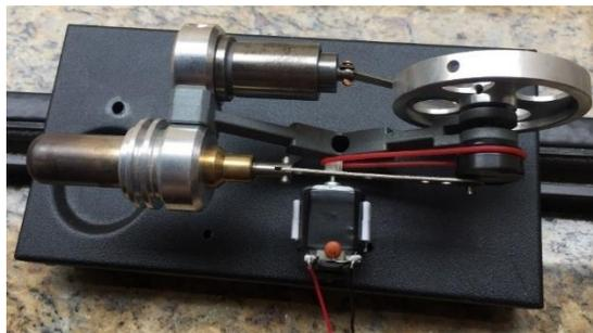
Figura 15: Motor Stirling ligado ao gerador DC
