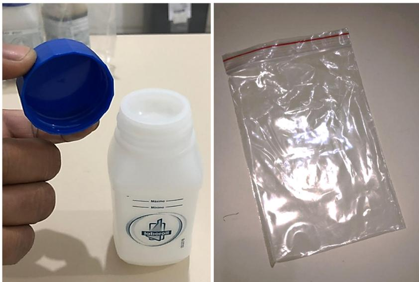
Figura 09: Frasco para coleta de amostra e plástico Zip-Lock
