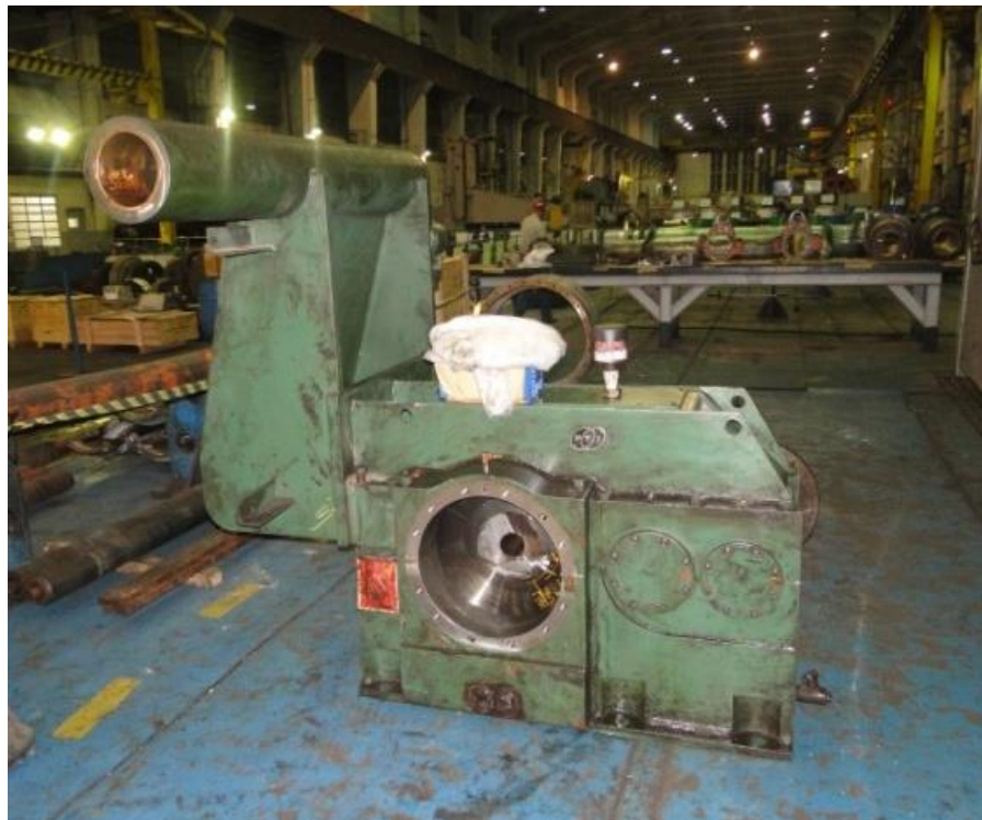
Figura 13. Caixa redutora da desbobinadora montada, ainda com o eixo quebrado
