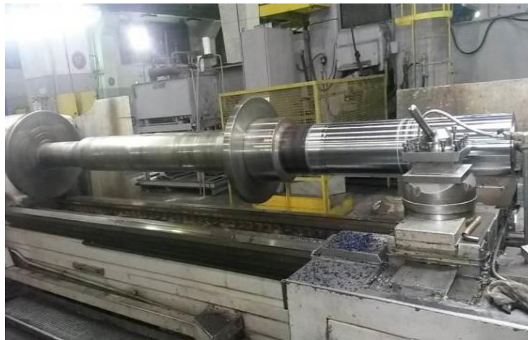
Figura 19: Usinagem do eixo após soldagem
