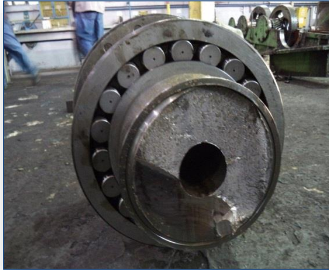
Figura 14. Detalhe da Fratura do Eixo de Mandril
