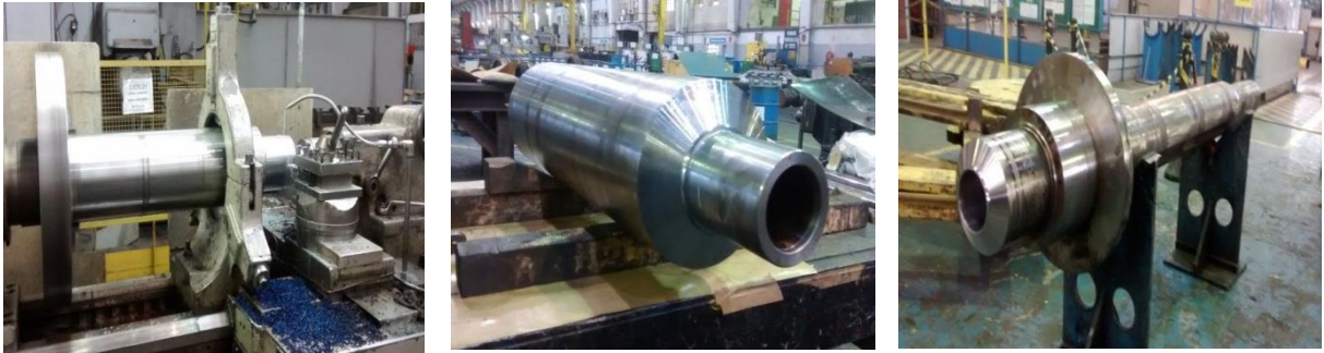
Figura 16: Usinagem da Ponta Postiça e do Eixo de Mandril
