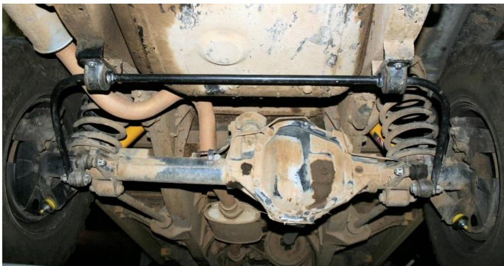
**Figura 15.** Barra estabilizadora (preta) utilizada na maioria dos automóveis modernos.
