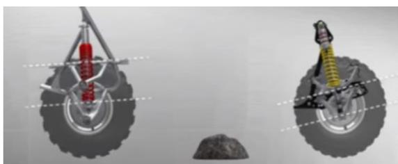
**Figura 38.** Sistema convencional a esquerda e sistema com uma maior recessão das rodas a direita.
