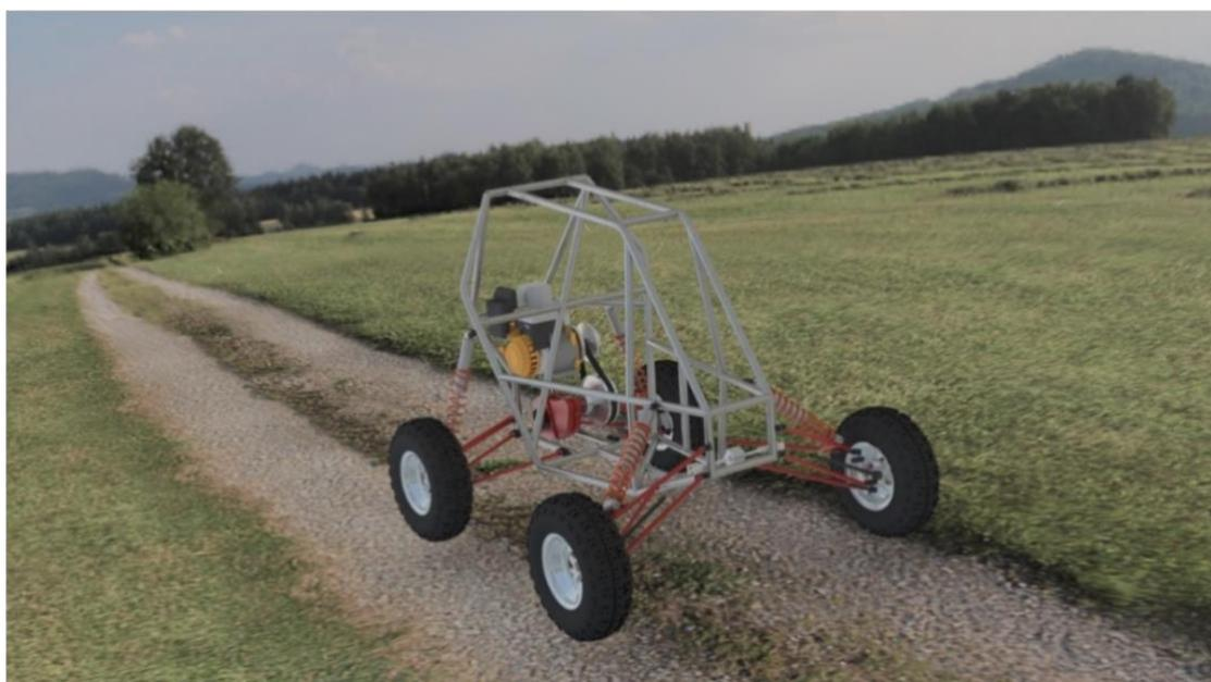
**Figura 64:** Protótipo com suspensão e direção finalizados visto de frente.
