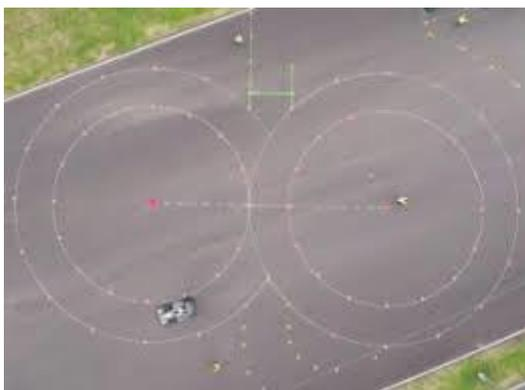
**Figura 49.** Raio de giro delimitado para realização do teste.
