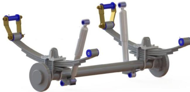
**Figura 17.** Suspensão *Hotchkiss*.
