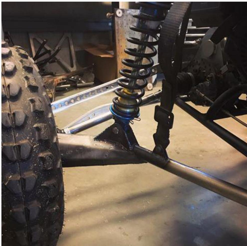
**Figura 22.** Geometria de suspensão *multi-link* com três links.
