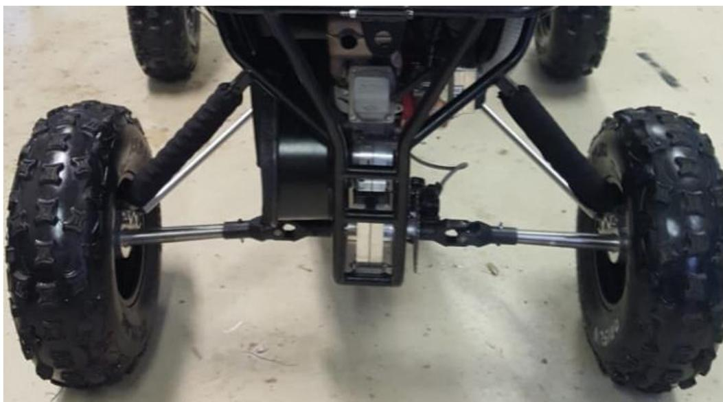
**Figura 25.** Geometria de suspensão do tipo *swing axle*.
