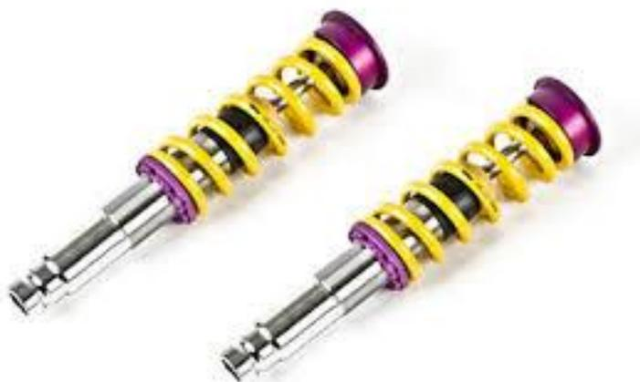
**Figura 16.** Mola helicoidal associada a um amortecedor.
